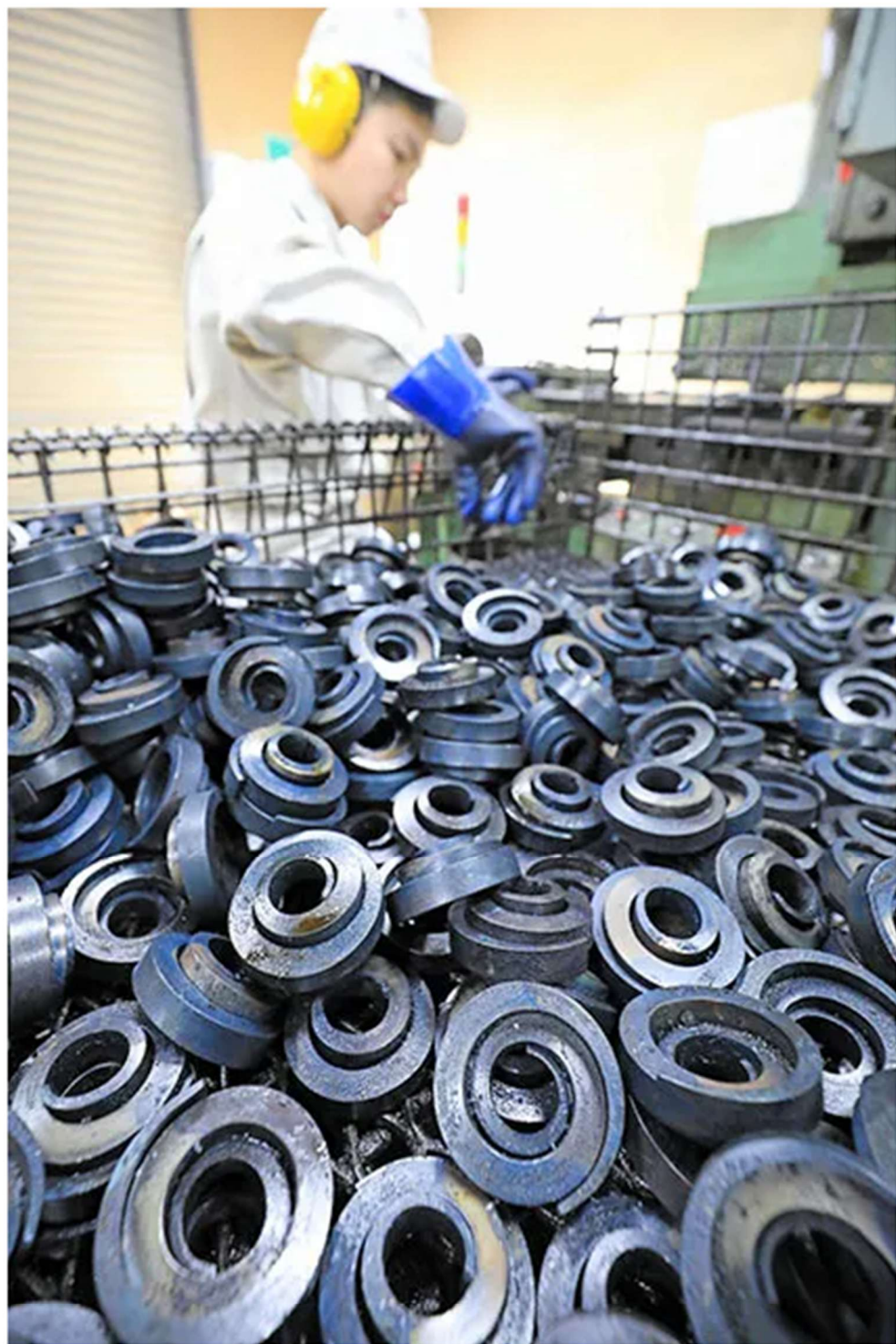
札幌市営地下鉄や東京メトロで使われている軌道用Vバネ（北波智史撮影）
